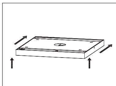
6. Plaats het frame over de montagebeugel omhoog en schuif het in de schroefsleuven.
