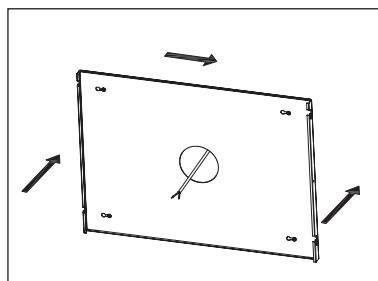
2. Plaats de montageplaat en voer de schroeven door de sleutelgatopeningen. Beweeg naar rechts zodat de montageschroeven in de smalle uiteinden van de sleutelgatsleuven schuiven. Draai de schroeven vast om te zorgen dat de plaat tegen het plafond is bevestigd.
