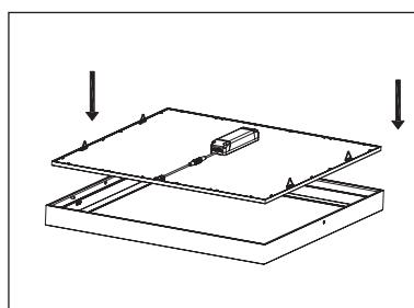
4. Bevestig het LED-paneel in het opbouwframe en sluit de driver aan op het paneel.
