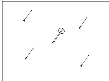
1. Gebruik de montagebeugelplaat om vier boorgatlocaties (max. 6 mm) op het montageoppervlak te markeren. Boor de gaten en bevestig de schroeven samen met de meegeleverde plastic ankers.
